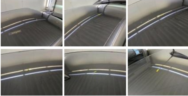
Dak, Hagelschade, Uitdeuken zonder spuiten (hagelschade)
