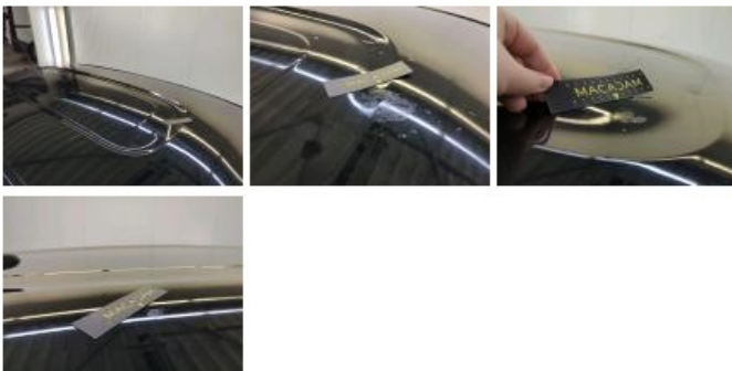
Dak, Chemische schade, Herstellen en spuiten (compleet)
